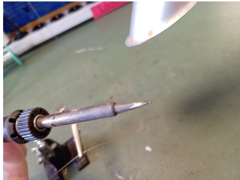
Figure 16: Lödningsjärnet har ingen silverspets
