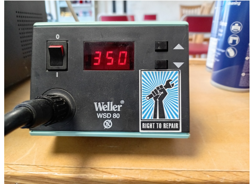
Figure 12: Sätt temperaturen på 350 grad Celsius
