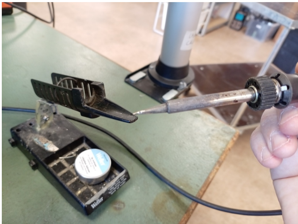
Figure 15: Lödningsjärnet har en silverspets
