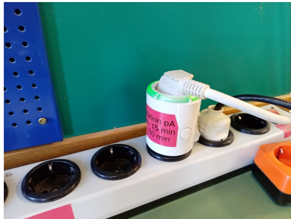
Figure 4: Tryck på den runda knappen åt sidan av lödningstimern
