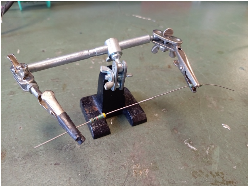
Figure 17: Sätt två resistorer mot varann i en hjälpande hand
